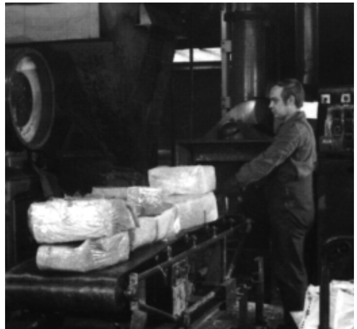
Rohkautschuk wird zu einem Innenmischer geführt.
