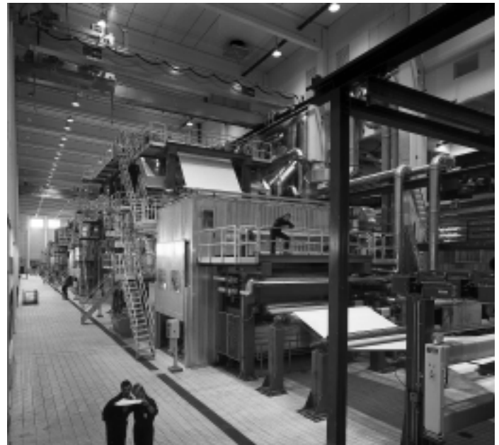
Streichmaschine zur PM 3
