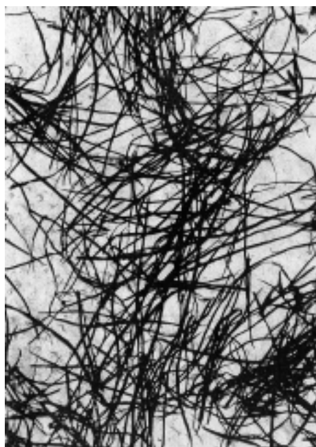
Zellstoff-Fasern, ungemahlen Lichtmikroskopische Aufnahmen 1:20
